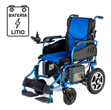
La silla de ruedas eléctrica plegable con batería de Litio de 15 Ah LEVEL 3 es muy ligera, el chasis está fabricado en aluminio. Sus dos potentes motores de 200 W cada uno, ofrece una generosa autonomía para este tipo de sillas electrónicas de hasta 15 km. Plegable sin necesidad de desmontar la batería y con respaldo abatible, LEVEL 3 es fácil de cargar en un maletero. Cuenta con un cómodo respaldo y unos reposabrazos abatibles para facilitar las transferencias laterales.
