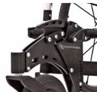
Robusto sistema con 3 puntos de anclaje en el chasis.
