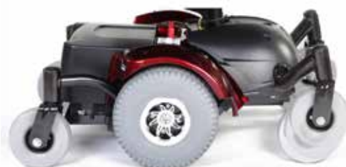
Ruedas delanteras con suspensión
